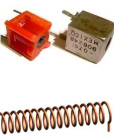
Tension aux bornes d'une bobine :  $U_{AB} = L \frac{di}{dt} + r i$
