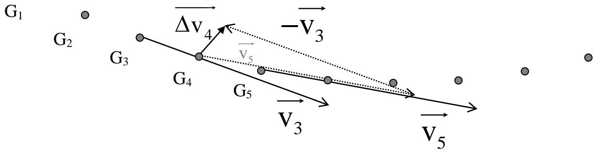
Graphiquement on mesure  $\|\overrightarrow{\Delta v_4}\| = \Delta v_4 \rightarrow 1,1 \text{ cm}$  ; avec l'échelle des vecteurs vitesse  $\Delta v_4 = 0,11 \text{ m.s}^{-1}$ .
