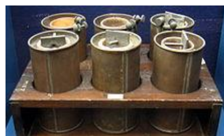
Piles Daniell (1836) : le zinc est ici au centre de la pile et le cuivre à l'extérieur. Les deux sont séparés par une membrane poreuse.
