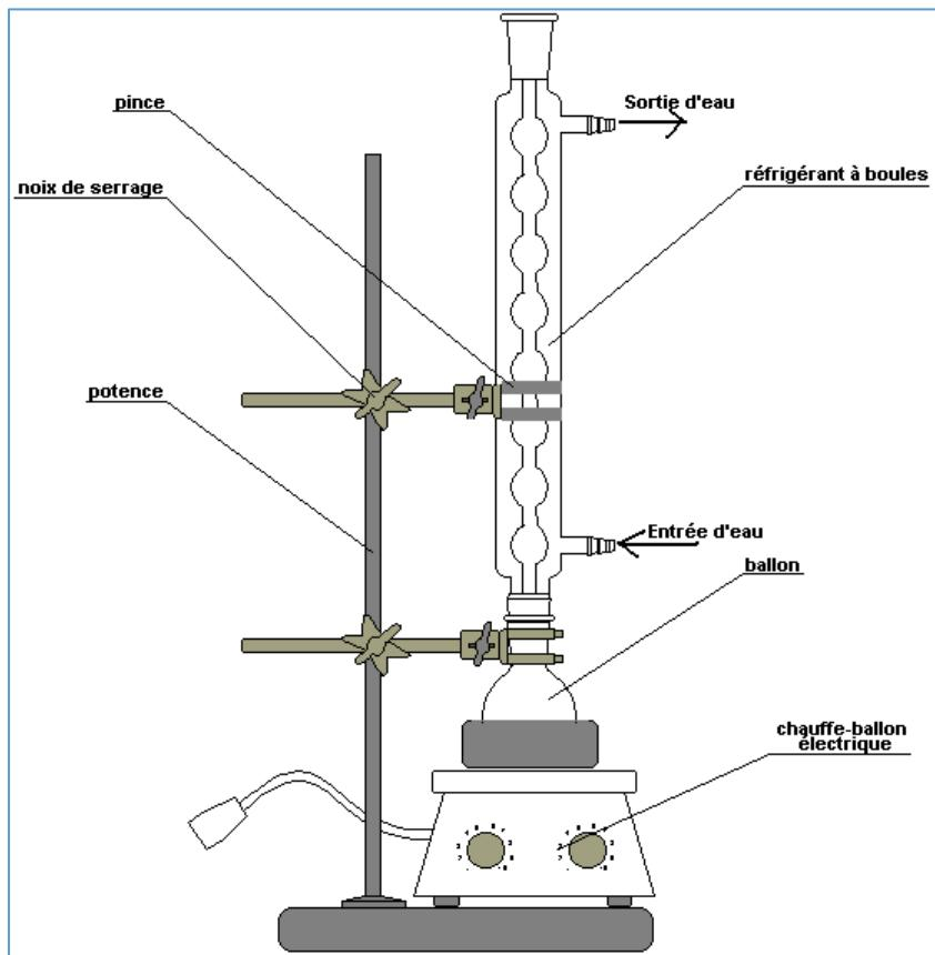
Le chauffage à reflux permet de réaliser à chaud (et donc plus rapidement) une transformation chimique ou (autre processus physico-chimique). Les vapeurs en s'élevant dans le réfrigérant se condensent et retombent dans le milieu réactionnel ; on limite alors considérablement les pertes de matière.
