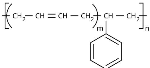
Le styrène-butadiène (SBR) est un copolymère du butadiène et du styrène. Très utilisé dans la fabrication des pneumatiques.
