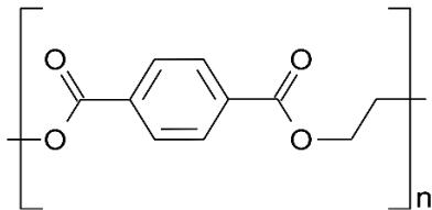
Le polytéraphthalate d'éthylène (PET). La fibre textile PET est de plus en plus utilisée dans la fabrication de vêtements.
